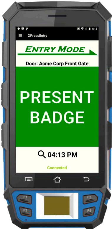
El individuo presenta tanto su insignia como sus huellas dactilares en el dispositivo móvil, identificándolo mediante el uso de una autenticación completa de 2 factores.
